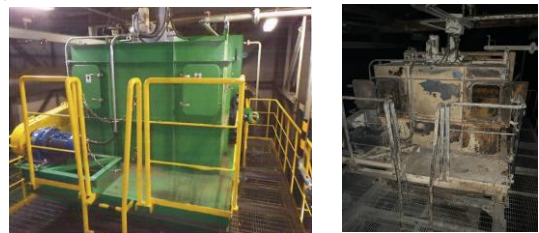
▲常総環境センターの火災事故の様子 (左：通常時 右：焼損時)
