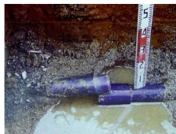
配水管の損傷や継手抜け
