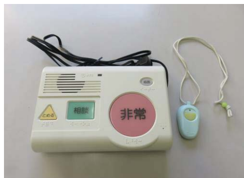
緊急通報装置
