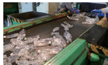
ペットボトルに異物が混入していないか、手作業で確認
