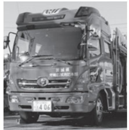
更新となりました。主な装備は、圧縮空気泡消火装置(CAFS)で、水と消火薬剤の混合液に圧縮空気を入れて泡を作り、消火する装置です。少量の水で高い消火能力を発揮することができ、今後の地域防災への貢献が期待されます。
