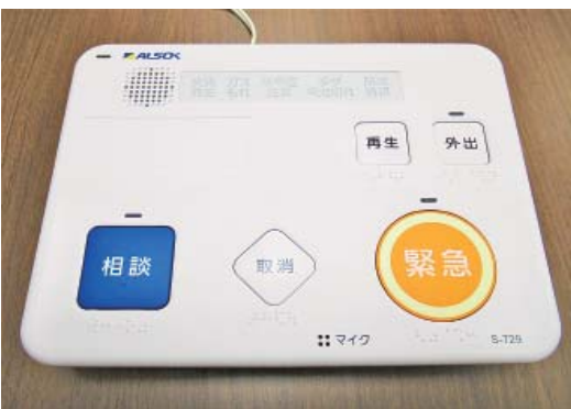
緊急通報装置
