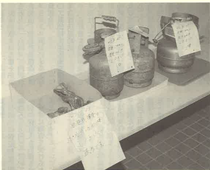
爆発事故の原因となったガスボンベの破片
