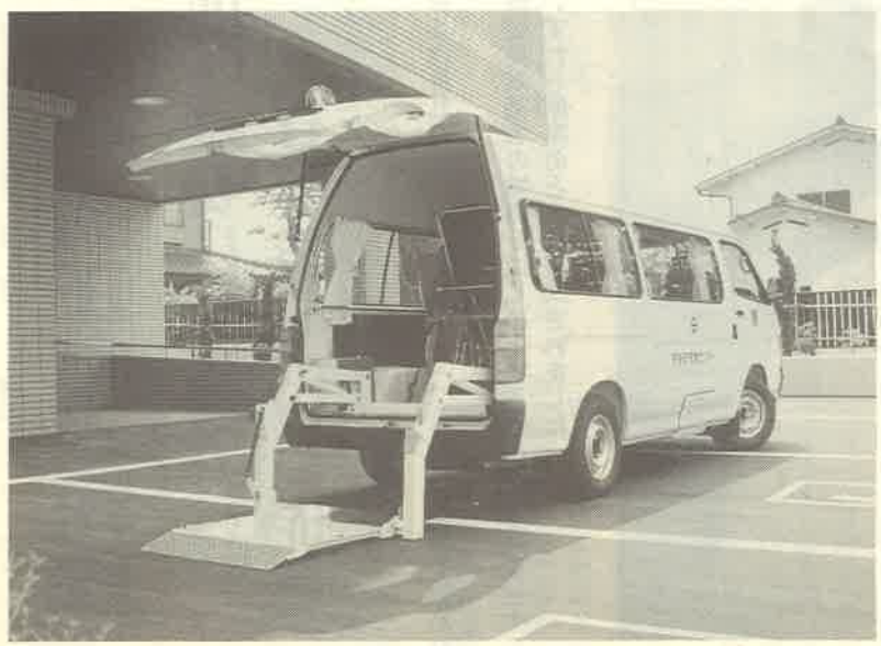
保健センターに配備されたリフト付ワゴン車
