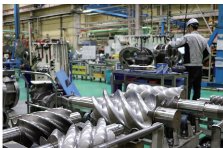
工場内では、冷蔵・冷凍技術を支える圧縮機が、次々と組み立てられています。
