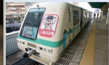
電気動力にゴムタイヤで走行する交通システム 1周14分、3~4便/時間で運行しています。
