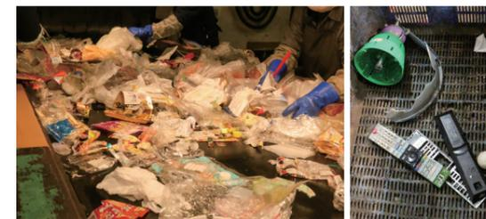
プラスチック製容器包装の選別作業。この日はプラスチック製のおもちゃ(不燃ゴミ)とリモコン(小型家電)が混入。
