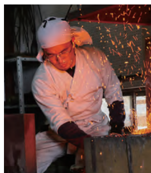
日本刀の材料「玉鋼」を叩き伸ばす作業。一本の日本刀を作るのに、何十個もの「玉鋼」を熱して叩き伸ばし、まとめる作業を繰り返すそうです。
